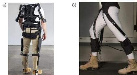
Рис. 1. а) мягкий экзоскелет; б) жесткий экзоскелет с бионическим каркасом
