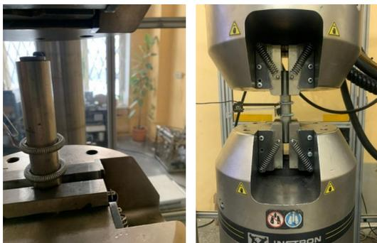
Рис. 2. Образец в испытательной машине Instron 8850 с датчиком растяжения
