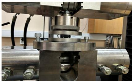
Рис. 1. Опыт на сжатие образца на испытательной машине Z100, Zwick/Roell
