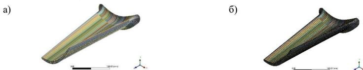
Рис. 1. а) Твердотельная многосекционная модель рабочей лопатки; б) конечно-элементная модель
