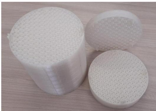
Рис. 2. Внешний вид теплообменной насадки
